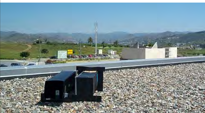
Recintos Portátiles de Prueba (RPP) ubicados en el lugar de emplazamiento de la nueva terminal de pasajeros del aeropuerto de Málaga en España, para determinar el recurso lumínico disponible en el sitio. Proyecto desarrollado por GOP Oficina de Proyectos, Madrid, con la asesoría ambiental y energética de los Arqs. Jorge Salazar y Alexander González.
